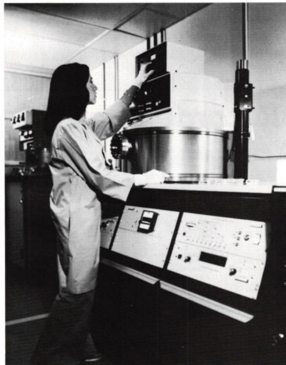
Vacuüm-kamer en besturingselektronica voor vervaardiging van dunnefilm-druksensoren volgens het sputter-procédé (foto Bell & Howell).
