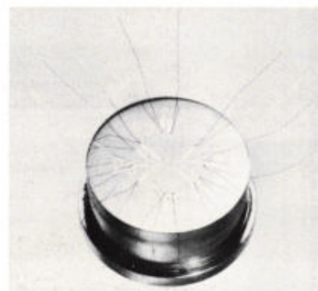
Afb. 4. Druksensorelement, bestaande uit dunnefilm-rekstrookjes op een siliciumdioxide-substraat dat direct op het stalen membraan is gesputterd (foto Bell & Howell).
